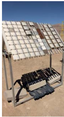
Setup para estudio de corrosividad atmosférica según norma ISO 9223, en colaboración con DLR
