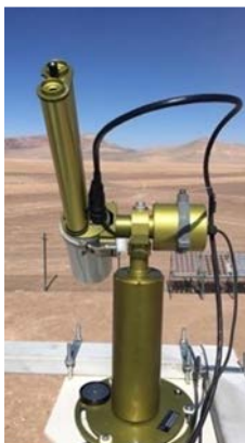
El sunphotometer, incluido en la red Aeronet de la NASA, proporciona información sobre el contenido de aerosoles atmosféricos, agua, ozono, NO 2 , distribución de tamaños de partículas atmosféricas, etc.
