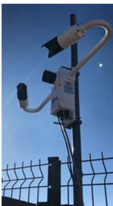
El sensor de visibilidad monitorea las condiciones climáticas y atmosféricas locales, por ejemplo, visibilidad (MOR), niebla (camanchaca), precipitaciones (mm), n° partículas precipitadas, etc.
