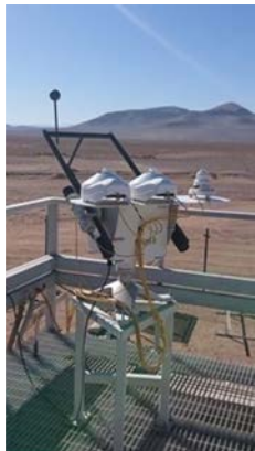
Setup para la medida del recurso solar en banda ancha y en UVA y UVB. Los componentes de la radiación solar medidas son: GHI, DNI y DHI.
