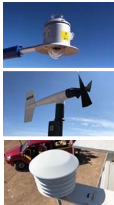
Otras variables de interés que se miden en la PSDA: albedo, velocidad y dirección del viento, humedad relativa, temperatura ambiente y presión atmosférica
